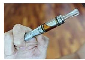
液体が補充できるようになったペン型の第二世代の電子たばこ<sup>[2]</sup>。
