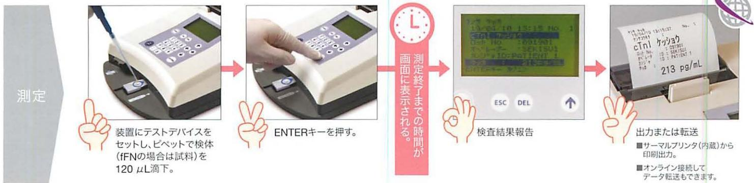
装置にテストデバイスをセットし、ピペットで検体 (fFNの場合は試料) を 120  $\mu$ L 滴下。
